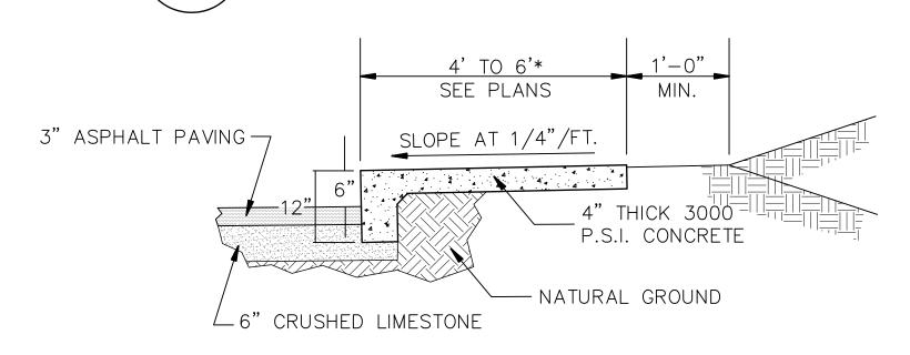
SIDEWALK AT ASPHALT PAVING
